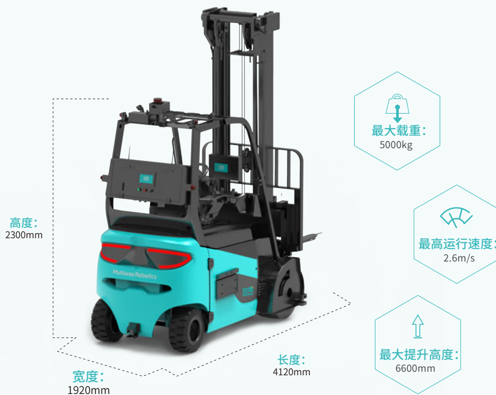
平衡重式无人叉车MW-E系列
